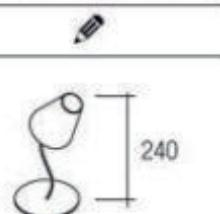
Luminaria de sobremesa, pie de tubo de acero base de chapa, pantalla en tela serigrafiada. Interruptor incorporado.
