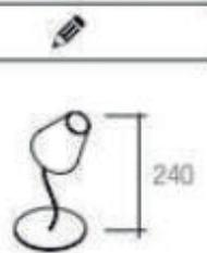
Luminaria de sobremesa, pie de tubo de acero base de chapa, pantalla en tela serigrafiada. Interruptor incorporado.
