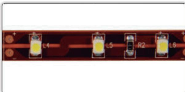
TIRA IP20. led en tira continua de 5mts de longitud, con soporte de tira adhesiva de alta calidad. La tira permite ser cortada cada 50mm. (3 leds).
